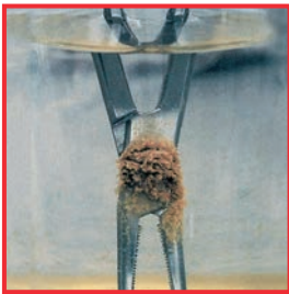
Formación de óxido por inmersión durante varias horas en una solución fisiológica salina
