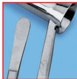
Consecuencia: Instrumentos con restos de cal
