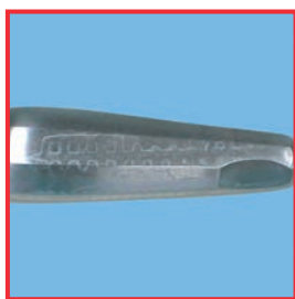
Arrastre de restos de productos de limpieza debido a un aclarado insuficiente
