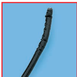
Hinchazón en el extremo distal de un fibroscopio
