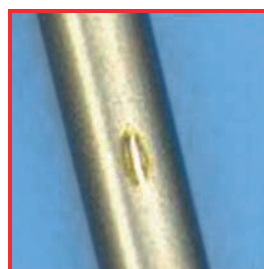
Corrosión de contacto: Acero inoxidable/Acero inoxidable
