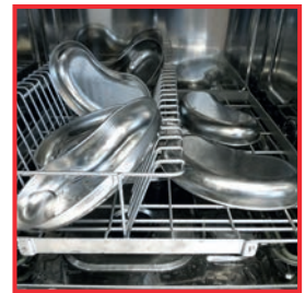
Carga equivocada/bandejas riñoneras volcadas
