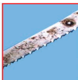
Daños en la capa de cromo parcialmente defectuosa. Causa: La humedad produce una formación de óxido del material base desnudo de acero normal
