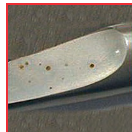
Ejemplo de corrosión de picadura
