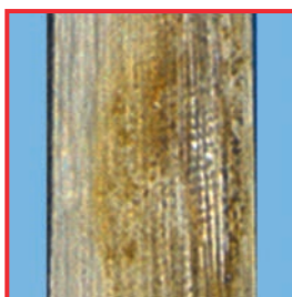
Punzón de huesos, la superficie de deslizamiento de la pieza corredera muestra corrosión por fricción
