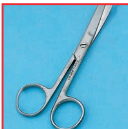
Tijeras con corrosión de picadura
