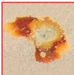
Ejemplo de corrosión de picadura
