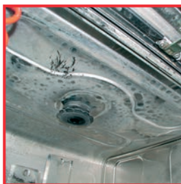
Cámara de aclarado con intensa calcificación
