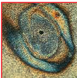
Ejemplo de corrosión de picadura
