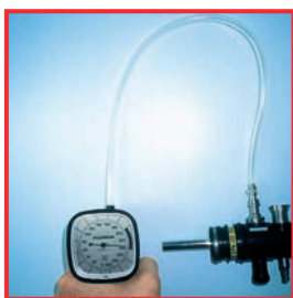
Prueba de estanqueidad manual en un endoscopio flexible
