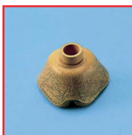
Grietas por envejecimiento en una mascarilla respiratoria
