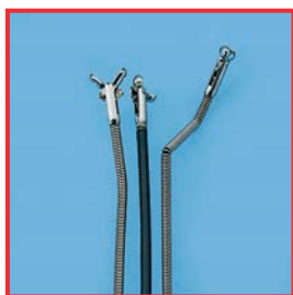
Pinzas de biopsia dañadas con fuerza
