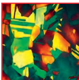
Alteración de los colores: microestructura austenítica de acero para instrumentos a prueba de óxido y ácidos (imagen con 500 aumentos)
